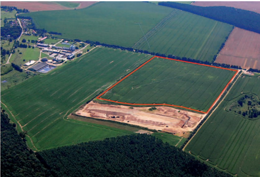
Der Kies wird im Trockenabbau in einem schmalen Graben gewonnen.
