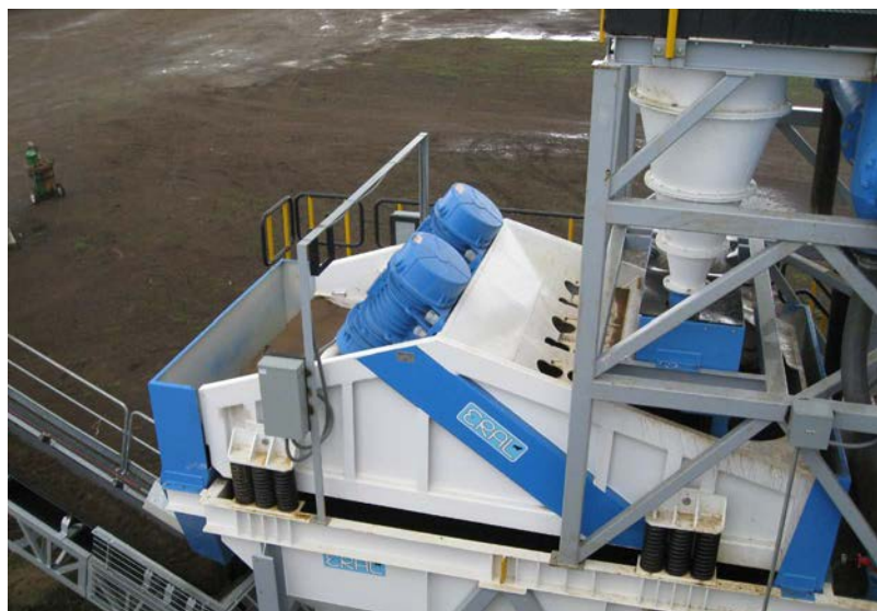
Modelos diversos de cribas de alta frecuencia para un proceso de clasificación preciso
