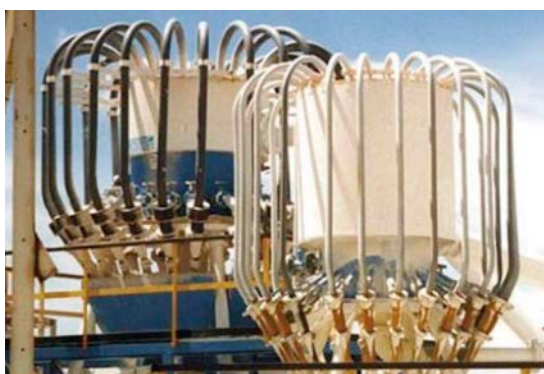
Hidrociclones – Recuperación de finos y ultrafinos – Módulos fácilmente reemplazables
