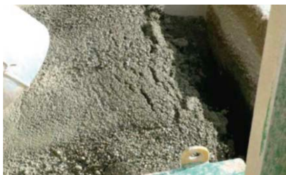
Criba de deshidratación – Deshidratación de grava y filtración de materiales finos – Montpouillan – Francia
