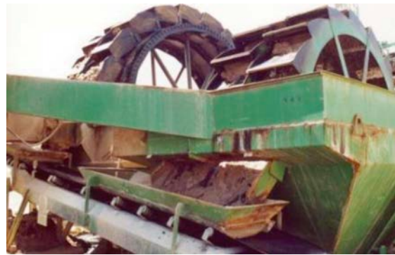
Norias hidráulicas. Largamente reemplazadas por sistemas más eficientes debido a sus limitaciones de rendimiento.
