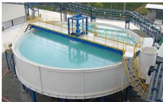
Introducción de distintos equipos nuevos en los procesos de lavado de áridos: ciclones, escurridores vibrantes y tanque espesador – Explotación de arena y grava – Eral – España
