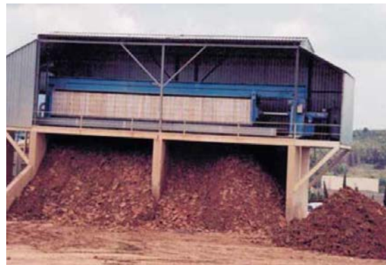
Tanque espesador y filtro de presa – Gravera – Instalación de Terrassa – Haymsa – España
