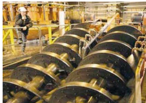
Clasificador en espiral - Rara vez utilizado en la industria de los áridos.
