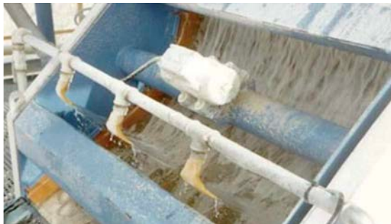
Criba curva operativa: Clasificación eficaz de materiales finos
