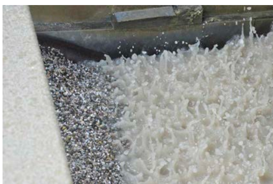
Criba de deshidratación – Deshidratación de grava y filtración de materiales finos – Montpouillan – Francia
