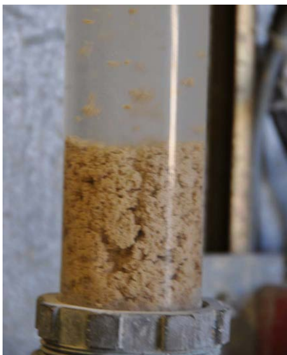
Fin del ciclo de control del agua mediante floculante, provocando la floculación del lodo y su sedimentación en el fondo.
