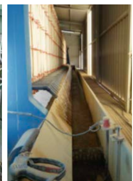
Filtro prensa – Proceso de deshidratación de lodos y recuperación de aguas residuales.
