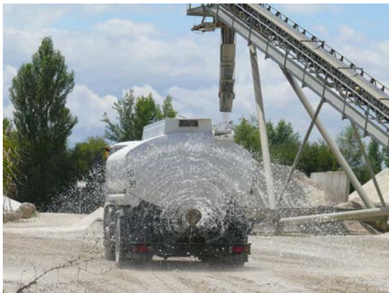
Riego de vías para la prevención del polvo - UNICEM
